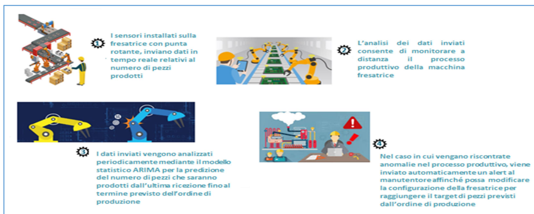
Figura 44 - Modello di funzionamento scenario predizione numero di pezzi prodotti
